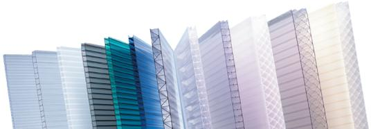
**Makrolon® multi UV 6/16-20** ist eine 6fach-Stegplatte aus Polycarbonat mit einer Dicke von 16 mm. Sie vereint hohe Lichtdurchlässigkeit mit hervorragender Wärmedämmung und ausgezeichneter Witterungsbeständigkeit. Die Platte ist leicht, schlagzäh und einfach zu verlegen.
